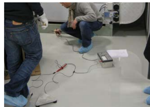
Misurazione della resistenza a terra secondo UNI EN 1081
