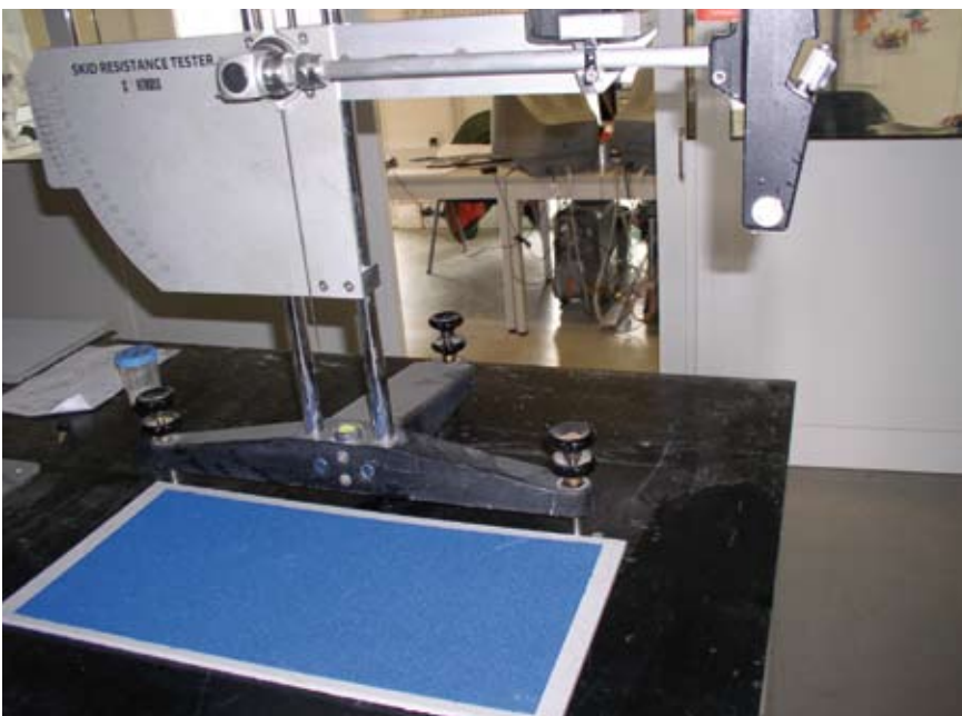
◀ Test di scivolamento slittamento previsto dalla UNI EN 1504/2.
